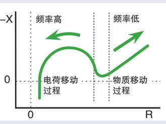
离子的运动等测量必须要用低频，IM3590可测量1mHz。上限频率是200kHz，能够测量溶液电阻。
